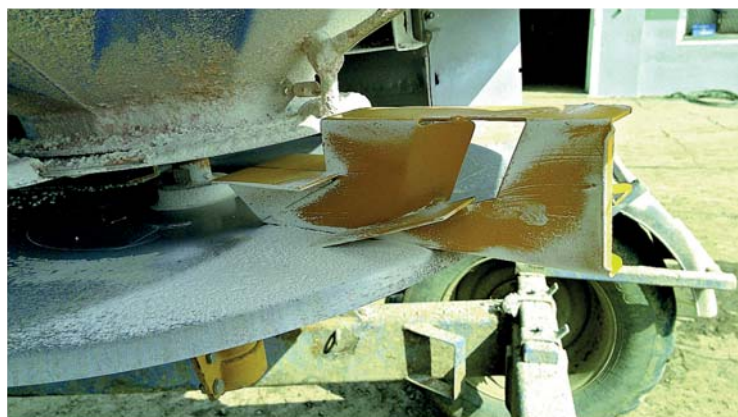
Slika 3. Lopatica za MAP (monoamonij fosfat) na rasipaču Bogballe M3W Figure 3. Steel wing for MAP on spreader Bogballe M3W
